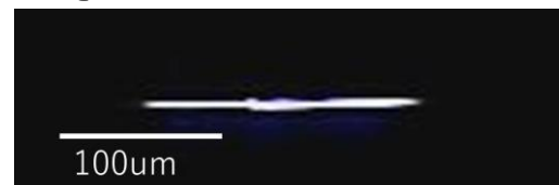
図6 メンブレン型DMによる再結合したSPM
