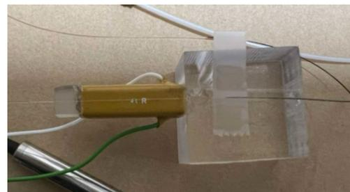
図 3.7 ファイバーに接着した PZT 素子の写真
