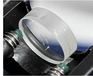
図9. Yb³⁺:Sc₂O₃ 結晶の破壊の様子
