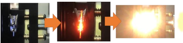
図6 シャーペンの芯を用いたアーク放電過程の遷移
