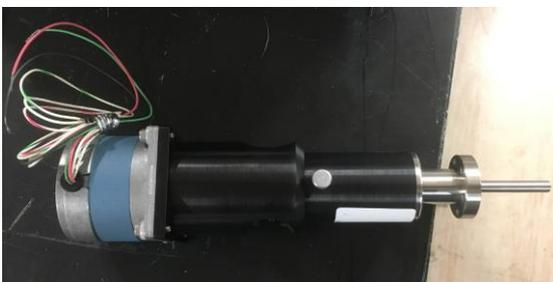
図 6. ステッピングモーター
