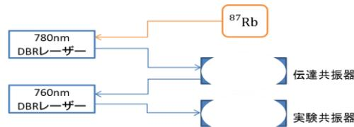
図 1. 実験共振器をロックするための機構
