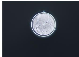
図 15 不活性ガスが不十分な時の端面
