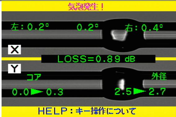
図 10 アーク放電によって加熱した時の融着画像
