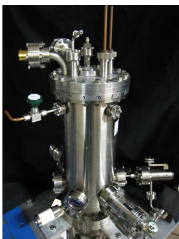
図 2 小型電子ビームイオントラップ 「CoBIT」
