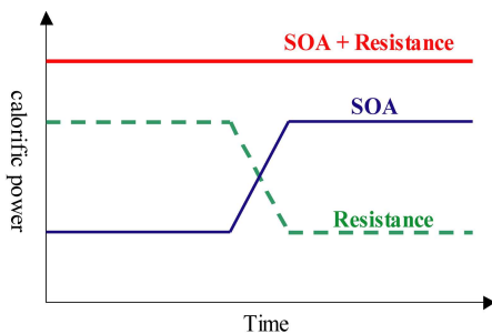
図 4 新方式温度制御の動作原理
