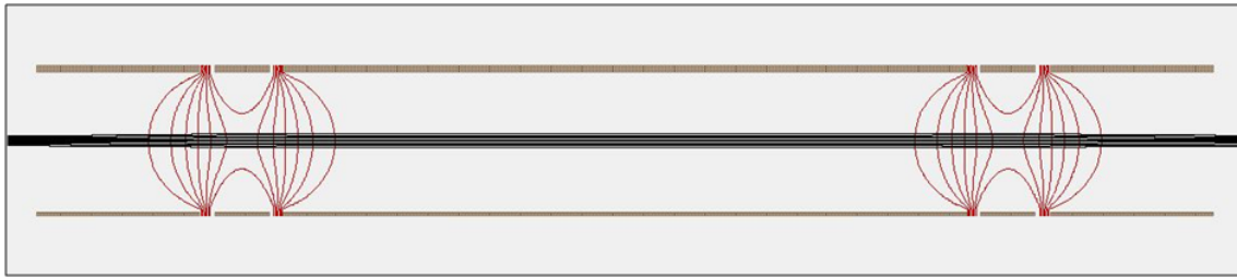
図 4(a). アイントゥエルレンズの形状決定。黒い線がイオンビーム、赤い線が等電位線。
