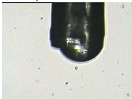
図9 液体レンズがファイバー中心に付かない様子
