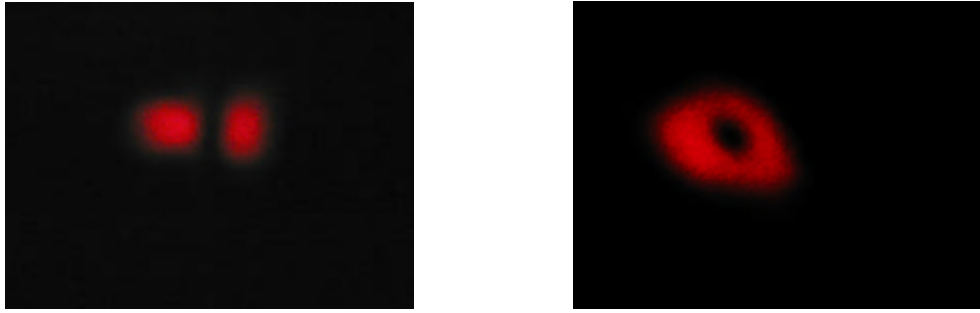
< 図4 TEM10モードでのHGビーム(左)とLGビーム(右) >
