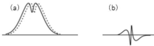
図 3.3 (a)ゼーマンシフトした飽和吸収スペクトルと (b)Doppler-free DAVLL 法のエラー信号 [8]
