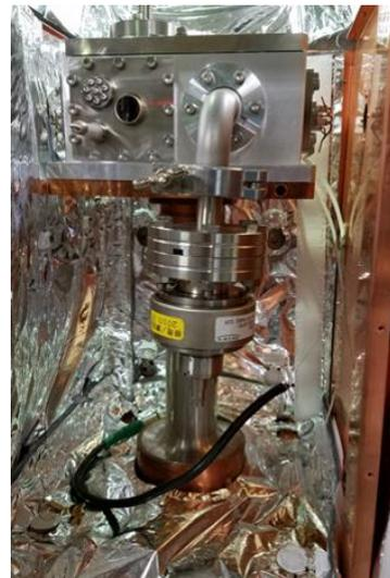
図3.2：クライオチャンバーを熱シールド内に設置した様子
