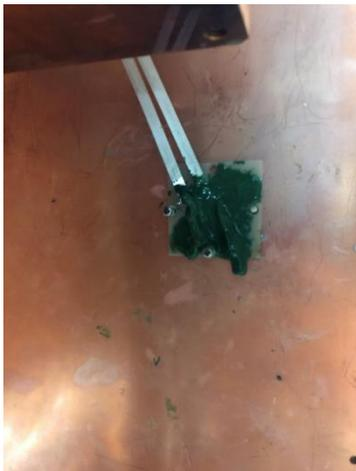
図3.3：窒化アルミニウム板の上から接着剤を付着させた様子
