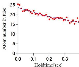
図 5: チューブ一本あたりの原子数の時間変化と式 4 によるフィッティング結果
