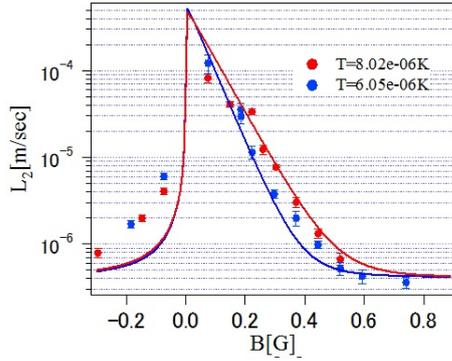
図7: 一次元系における二体ロス係数の磁場依存性と理論曲線との比較 赤線は  $T = 8.02 \mu\text{K}$ 、青線は  $T = 6.05 \mu\text{K}$  の理論曲線を示す。
