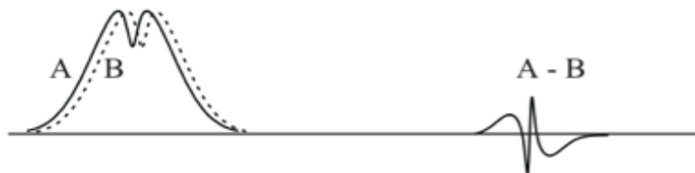
図 5：Doppler-free DAVLL の飽和吸収エラー信号
