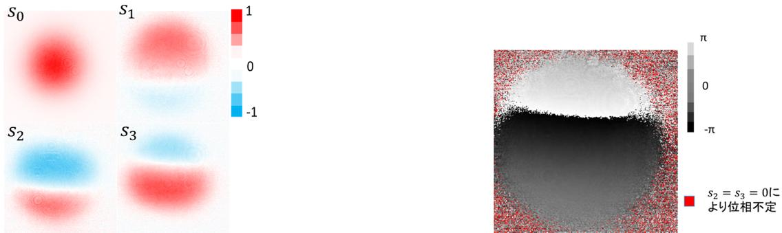
図 5: ダブルプリズムの回転角が  $90^\circ$  の状態でのストークスパラメータ ( $s_0$  は最大値が 1 となるように規格化、 $s_1 \sim s_3$  は規格化前の  $s_0$  で割った値) 図 6: ダブルプリズムの回転角が  $90^\circ$  の状態での p 偏光と s 偏光の位相差の分布
