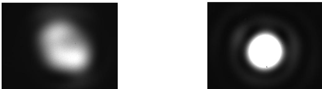
図 5: ビーム成形後のビームスポット。左の図は空間フィルタ径 15 $\mu\text{m}$ 、ND フィルタ (透過率 1%, 5%, 10%)、右の図は空間フィルタ径 10 $\mu\text{m}$ 、ND フィルタ (1%, 10%, 25%)
