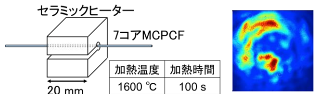
図11. 作製方法と観測した遠視野ビーム形状 (セラミックヒーター)
