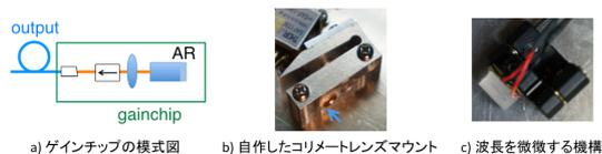
Fig. 4 回折格子型 ECLD の一部拡大図
