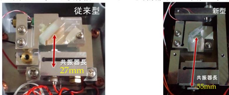
図 2 従来型の外部共振器型半導体レーザーと新規設計の外部共振器型半導体レーザー
