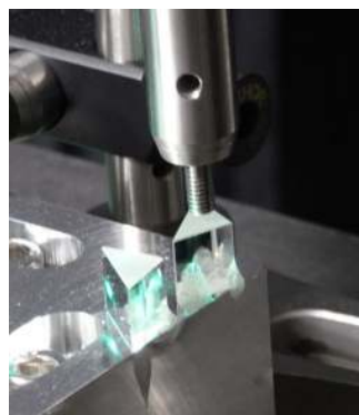
Fig.4 プリズムミラーを固定する治具の様子
