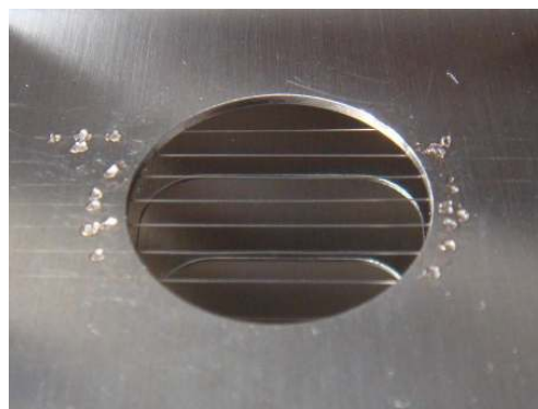
図8. 偏向器入口部に設置されたワイヤー
