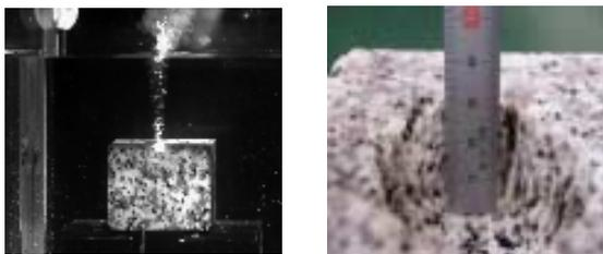
図3. CO<sub>2</sub>レーザーでの岩石破壊
