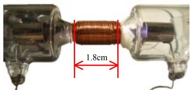
Fig.5 放電セルとコイル
