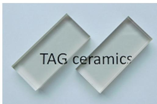
図 4. TAG セラミックス(10×30×5mm)
