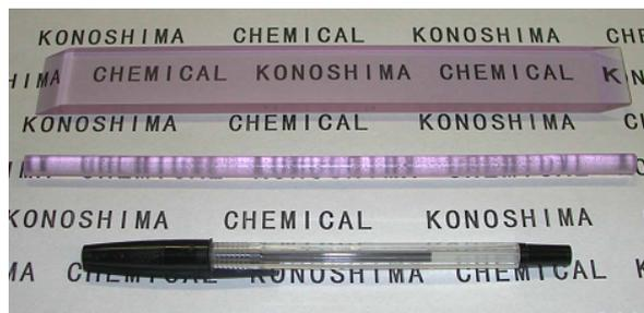
図 2. レーザー用 Nd 添加 YAG セラミックス
