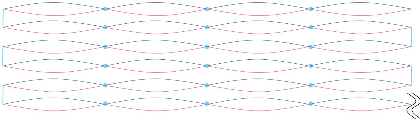
異なる2種類の金属線を接続して熱電対を作ります。
